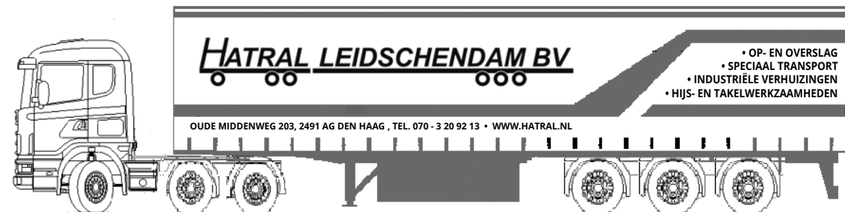
3-Assige Tautliner. Inwendige maten: 13,62 x 2,46 x 2,65 m. (lxbxh). Laadvermogen 27.000 kg
